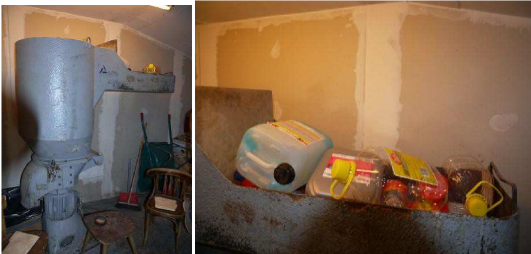
Abbildung 22 - Zerkleinerer für Plastik, Berghütte Salei
