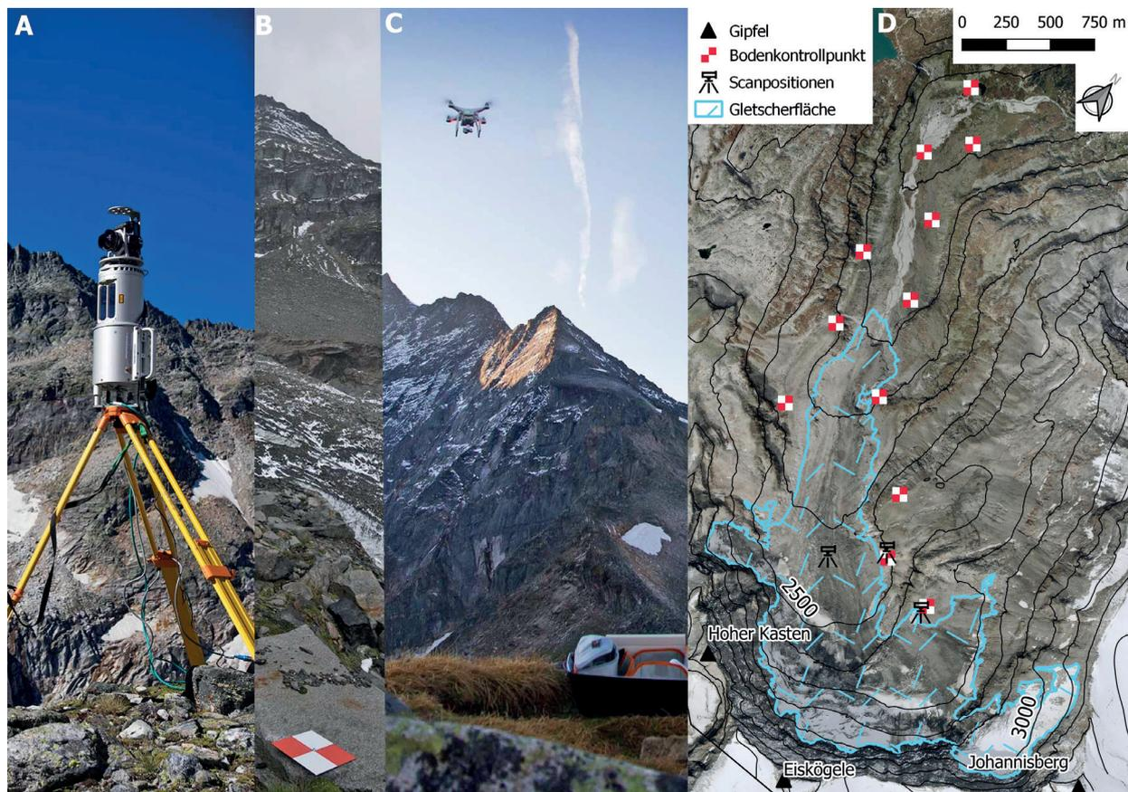
Abbildung 10: Monitoring von Oberflächenveränderungen im Untersuchungsgebiet Ödenwinkel. A: Terrestrisches Laserscanning, B: Bodenkontrollpunkt für UAS-Befliegung, C: UAS-Befliegung, D: Übersichtskarte mit Scanpositionen und Bodenkontrollpunkten, (Fotos: GEORESEARCH).
