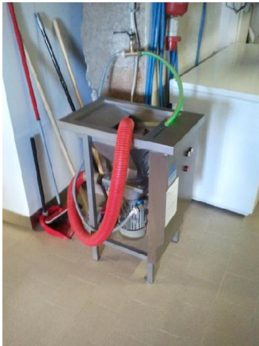
*Figura 18 - Trituratore con tubo (verde) aggiuntivo per incrementare la quantità d'acqua e tubo di scarico (rosso), Rifugio Des Alpes*
