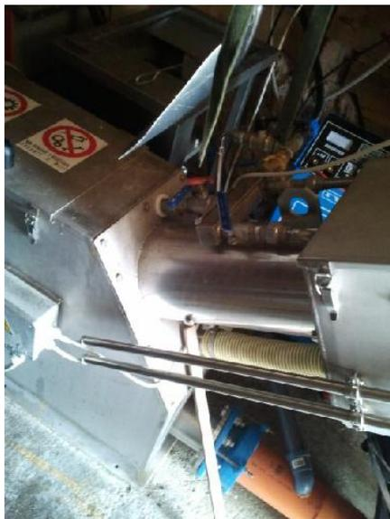
*Figura 24 - Tubo da 4cm di diametro del trituratore che si innesta nel tubo più grande prima di uscire con alta pendenza, Rifugio Pian dei Fiacconi*
